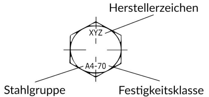
Beispiel einer Zylinderkopfschraube mit Innensechskant ISO 4762 (ersetzt DIN 912) aus A4-70
